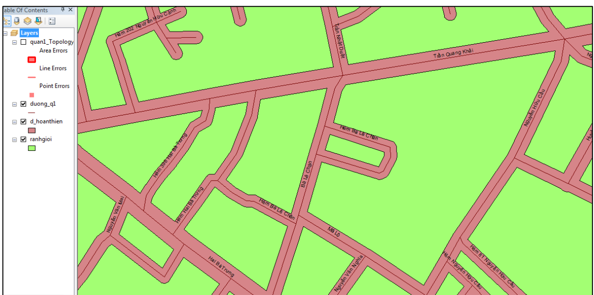
Hình 4.2. Kết quả gộp và sửa lỗi hình học các loại đường với độ rộng khác nhau
