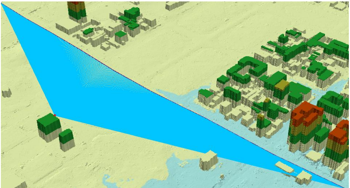
Hình 4.25. Kết quả thực hiện công cụ Construct Sight Lines (3D) với Sampling Distance 1 m
