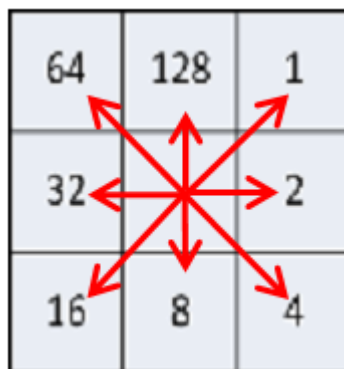
Hình 2-2. Mô tả hướng dòng chảy trong D8
