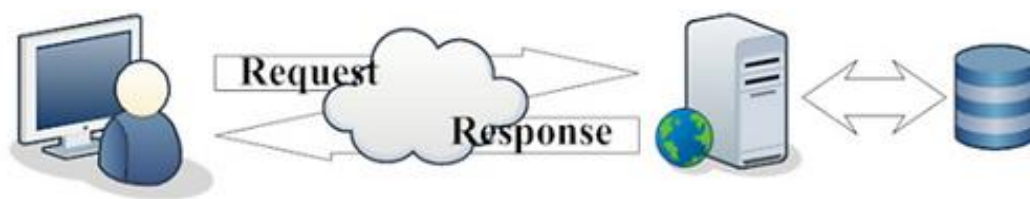
Hình 2.3: Sơ đồ kiến trúc ba tầng của WebGIS
